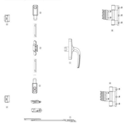
注:窗户的框与扇的组角连接必须牢固可靠,本配置适用于标准欧式 20 槽,本内平开组件必须配合欧式跟位撑,已达到最佳效果。
